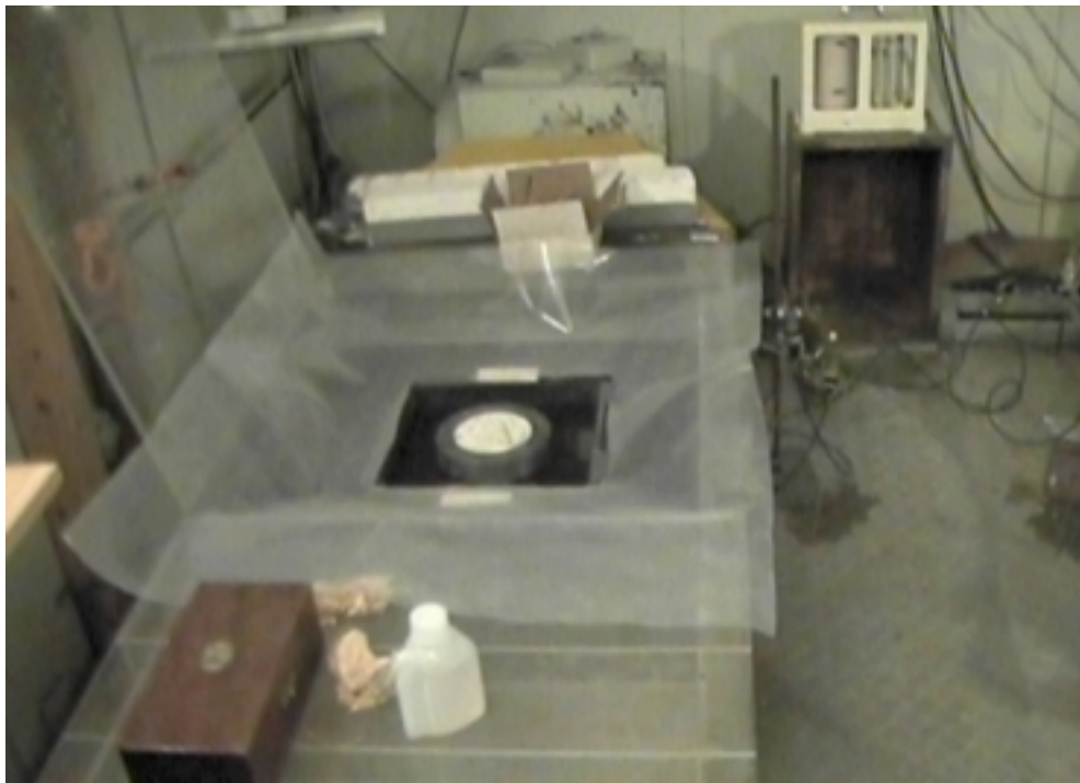
Figur 2: Vindtunnel, hvori den støbeblære form er placeret. For at undgå betonspild omkring vægten, er området tildækket med plast. Til højre for tunnelen ses tryktransducerne monteret i stativ.
