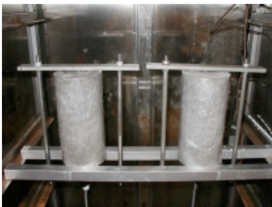
Figur 5: Prøveemner i klimaskab (billedet til venstre). På begge cylindre er monteret en måleramme med en deformationstransducer placeret nederst (billedet til højre). De lodrette afstandsstænger i målerammen er fremstillet af invarstål, der har en temperaturudvidelseskoefficient på ca 10 % af betons.
