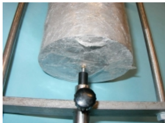
Figur 5: Prøveemner i klimaskab (billedet til venstre). På begge cylindre er monteret en måleramme med en deformationstransducer placeret nederst (billedet til højre). De lodrette afstandsstænger i målerammen er fremstillet af invarstål, der har en temperaturudvidelseskoefficient på ca 10 % af betons.
